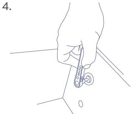
Schrauben Sie beide Armlehnen mit jeweils vier Inbusschrauben und vier Unterlegscheiben mit der mitgelieferten Ratsche an. Drehen Sie die Schrauben erst fest, wenn alle Schrauben bereits leicht angezogen sind.
